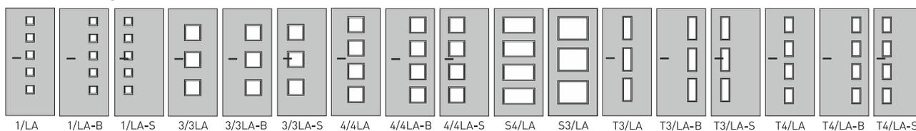
Výřezy typu 3/3LA (B, S) a 4/4LA (B, S) nelze u šířky dveřního křídla 610 a 650 mm.
